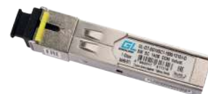
GL-OT-SG14SC1-1550-1310-I-D Промышленный SFP, WDM, 1 Гбит/с, одно волокно SM, SC, Tx:1310/Rx:1550 нм, 14 дБ, до 20 км
