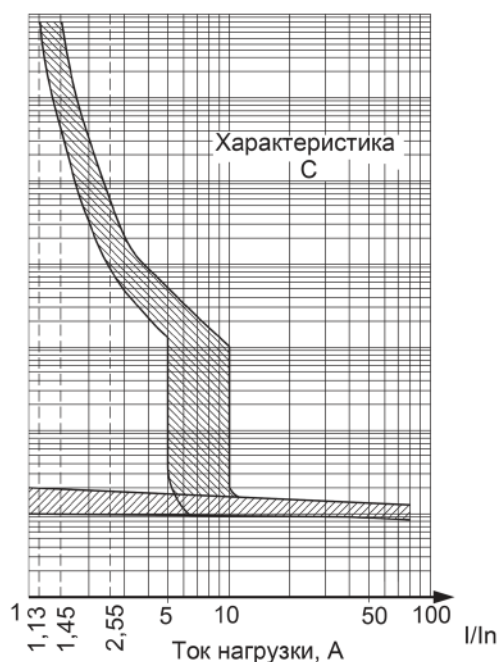
Защитная характеристика в условиях действия сверхтоков при контрольной температуре +30 °С, с холодного состояния, при пропускании тока через все защищенные полюса АВДТ
