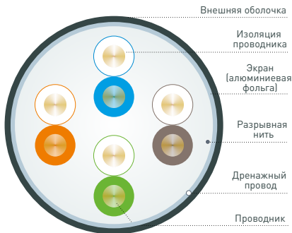
Рис. 2 – Конструкция кабеля F/UTP(количество жил 4x2)
