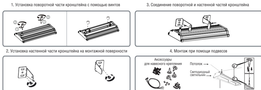
- Рис 1. Монтаж светильника при помощи подвеса -
